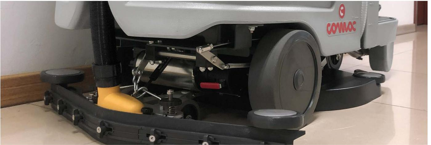
所有的部件都被车身包裹在内，遇到意外撞击时，降低损坏风险，避免额外的维修成本，延长部件的使用寿命
